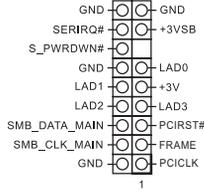
此接頭支援信賴平台模組 (TPM) 系統，可確保儲存金鑰、數位憑證、密碼及資料的安全。TPM 系統也能強化網路安全、保護數位身分並確定平台完整性。
