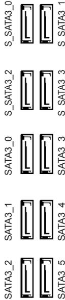
這十組 SATA3 接頭皆支援內部儲存裝置的 SATA 資料纜線, 最高可達 6.0 Gb/s 資料傳輸率。若連接背後 I/O 上的 eSATA 連接埠, 內部 S\_SATA3\_3 將不會作用。如果已佔用 Ultra M.2 插槽, 內部 S\_SATA3\_2 將無法作用。
